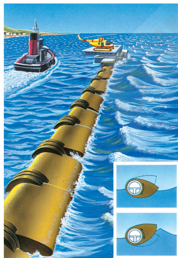
Figura 1 Schema di funzionamento delle «anatre di Salter».
